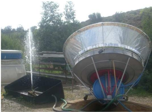
**Bild 9a: Sunpulse Wasserpumpe**
